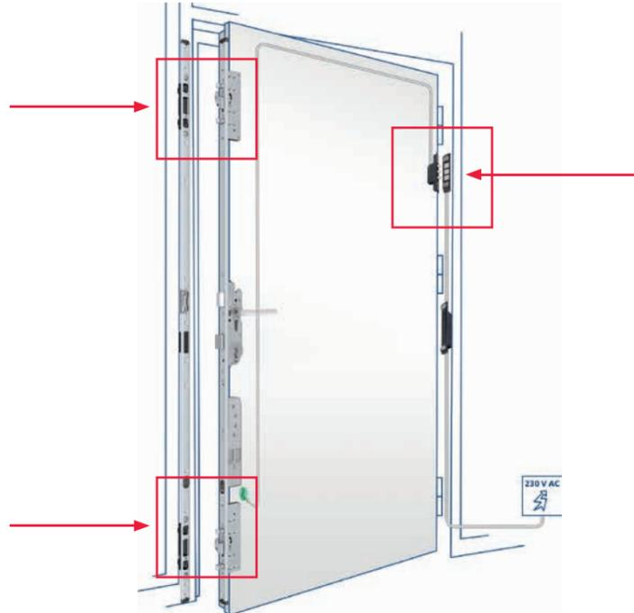
Système invisible Ouverture intérieure sans clé (système anti-panique)
