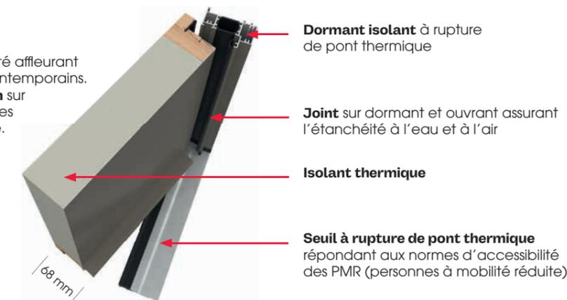
**Dormant isolant** à rupture de pont thermique
