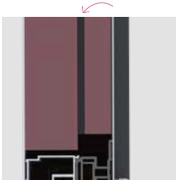
**Écran acoustique** de 5 mm d'épaisseur en option pour renforcer les performances phoniques : **jusqu'à 33 dB** pour un modèle plein (Sauf porte d'entrée cintrée).
