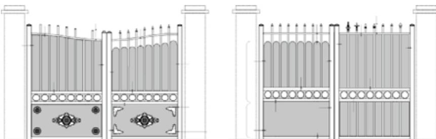
*Le remplissage en festonnage s'arrête à 100 mm de la traverse haute, alors que le remplissage droit monte jusqu'à 5 mm de la traverse haute en forme droite.*
