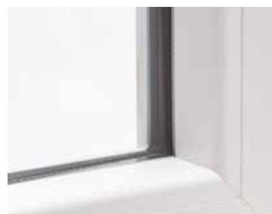
Parclose contemporaine Deux esthétiques de parclores possibles avec joint d'assemblage masqué. Les parclores se démontent facilement (en cas de changement de vitrage).
